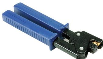
Пломбиратор – это устройство, позволяющее фиксировать на проволоке или шпагате пломбу из свинца или пластика.
